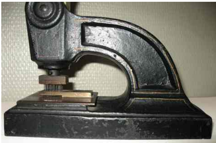
Detail naalden van een perforatiemachine
